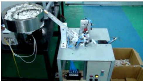
Hình 16. Hình ảnh thực tế máy đo lực ma sát của sản phẩm Clutch-Gear
